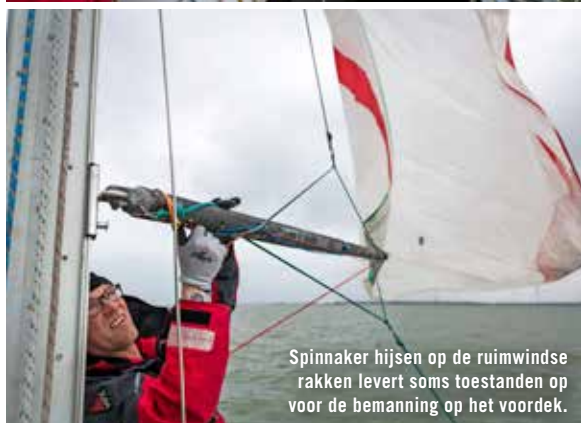
Onvoldoende voorbereiding bij het hijsen van de spinnaker: de neerhouder van de boom is nog niet vastgezet en de tweaker hangt los.
