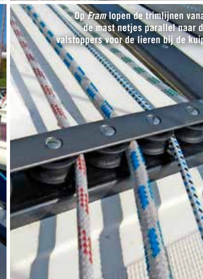
Labels op de valstoppers maken het trimmen overzichtelijk.
